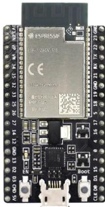
Gambar. 3 Contoh perangkat NodeMCU ESP32
