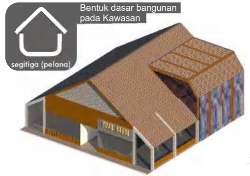
1 Bentuk rumah tradisional masyarakat mappi 2 Menghilangkan sistem struktur panggung karena site yang terletak pada daerah yang minim akan potensi banjir 3 Menghilangkan atap dan teras pada rumah adat, sehingga bentuk dasar bangunan simetris, dan konsisten 4 Menggunakan material yang di gunakan pada rumah tradisional ke bangunan pada site
