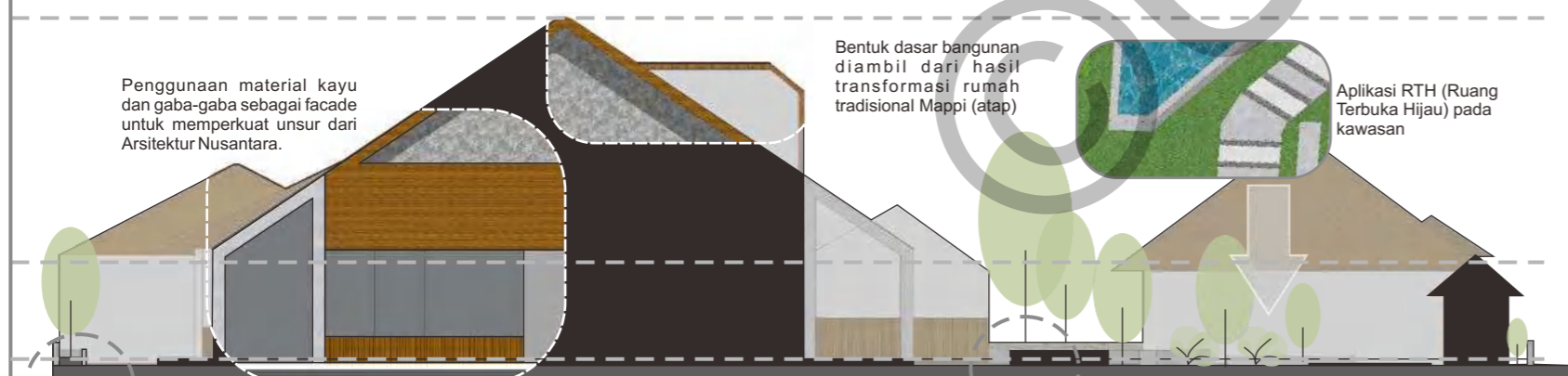
Penggunaan material kayu dan gaba-gaba sebagai facade untuk memperkuat unsur dari Arsitektur Nusantara. Bentuk dasar bangunan diambil dari hasil transformasi rumah tradisional Mappi (atap) Aplikasi RTH (Ruang Terbuka Hijau) pada kawasan Menggunakan lahan sisa sebagai area hijau Pengerasan pada beberapa titik yang tidak menyeluruh (penyediaan jarak 3-5 cm untuk penyerapan air hujan) Unsur aplikasi struktur goyang tidak diaplikasikan pada bangunan Karena pengaruh bentang yang lebar, sehingga material fabrikasi seperti baja lebih efisien digunakan. Unsur Struktur goyang pada Arsitektur Nusantara hanya di aplikasikan pada gazebo karena bentuk yang lebih minimalis. Proporsi/bentuk atap yang dominan
