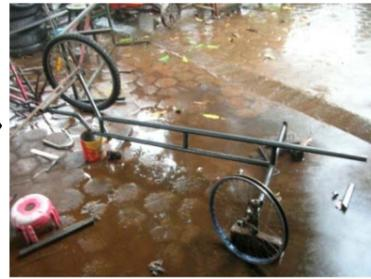
Uji coba dengan roda pada Frame
