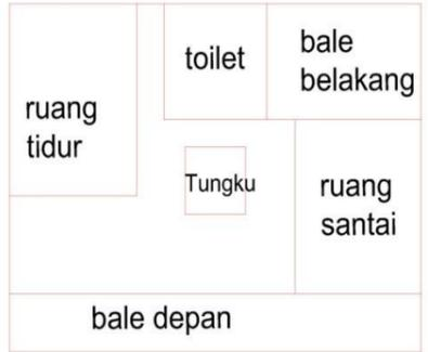
Bentuk desain denah yang baru yaitu memiliki 1 tempat tidur, dilengkapi dengan toilet. Tungku/perapian tetap diletakkan pada bagian tengah dan akan di lengkapi dengan cerobong asap.
