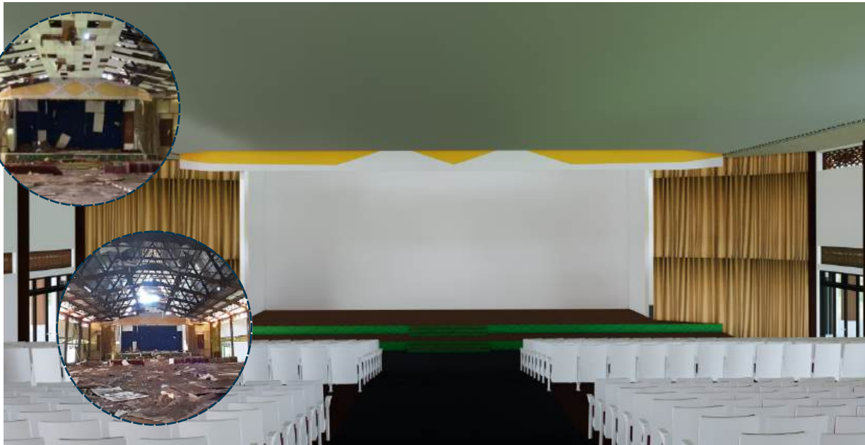
Menampung hingga 600 orang, Elemen akustik eksisting masih kurang optimal terutama pada layout kursi, jenis panggung, material dinding, bentuk plafon dan pada lubang angin yang mengelilingi gedung yang berpotensi membuat suara dapat bocor keluar
